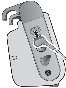
Figure 6-3 Connexion du câble ECG à l'unité Propaq M
