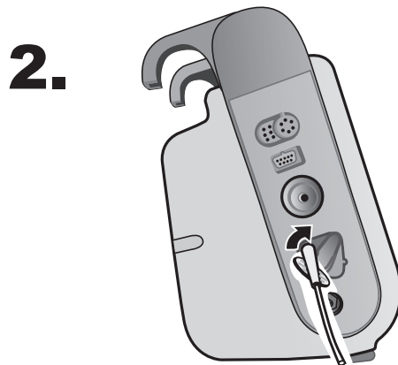
Figure 9-1 Branchement du connecteur de la tubulure de prélèvement sur la prise CO 2 de l'appareil
