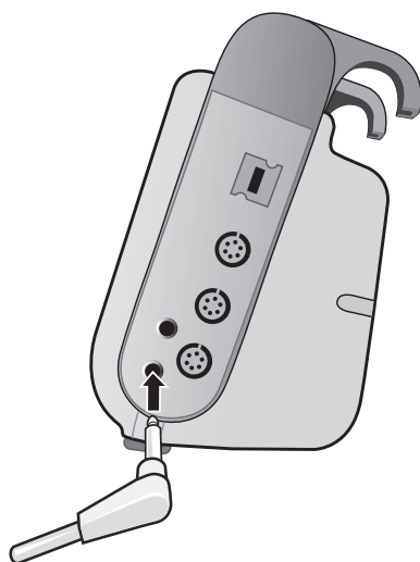
Figure 12-1 Connexion de la sonde de température à l'appareil Propaq M
