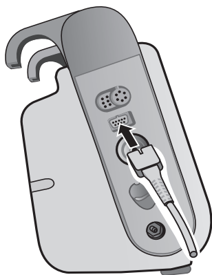
Figure 10-3 Connexion du capteur SpO 2 à l'appareil Propaq M
