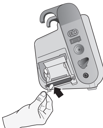
Figure 17-3. Nettoyage de la tête d'impression
